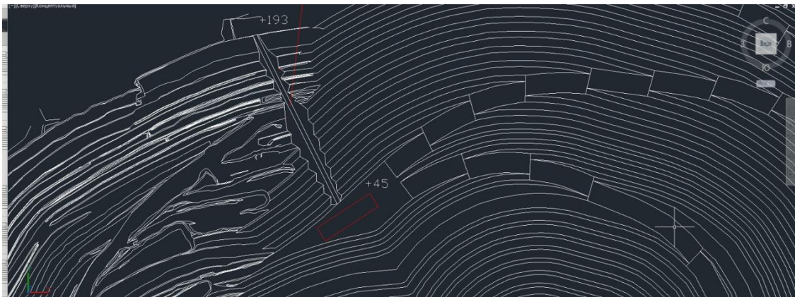
Рисунок 1 – Первое положение крутой траншеи под скиповый подъемник в северо-восточной части карьера между отметками горизонтов +45 и +193 м
