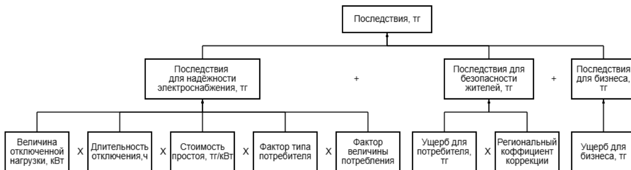
Рисунок 1 – Факторы, учитываемые при оценке последствий отказа оборудования
