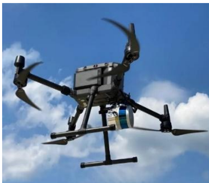
Рисунок 1 – Лазерный сканер TOPODRONE LIDAR 100 LITE
