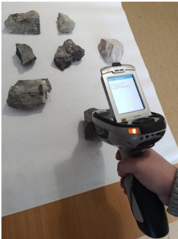
Рисунок 1 – Снятие показаний вещественного состава пород с помощью рентгено – флуоресцентного спектрометра XL3t
