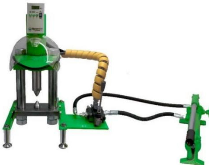
Рисунок 2 – Прибор ПСН-0.16.10 для измерения пределов прочности на сжатие, растяжение и сдвиг
