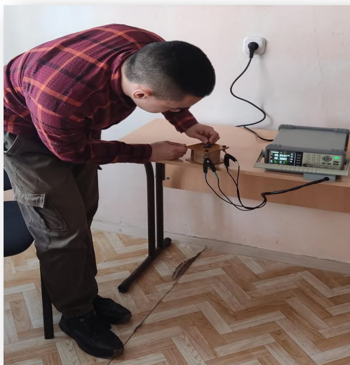
Рисунок 2 - Определение магнитной проницаемости горных пород
