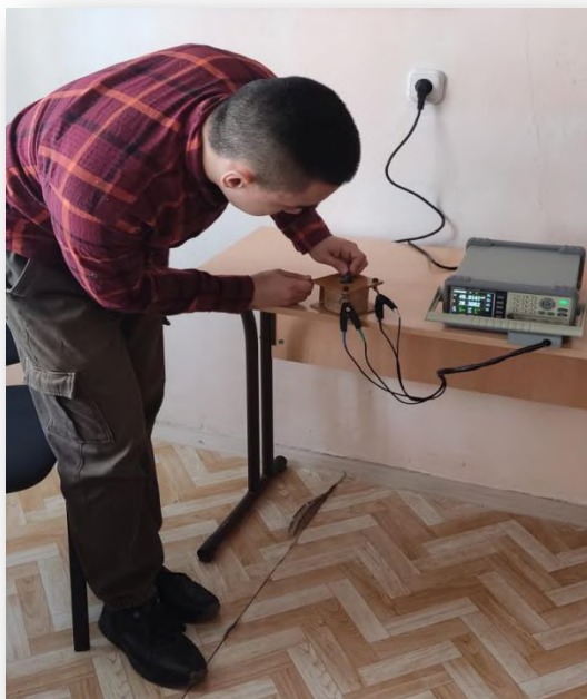
Рисунок 2 - Определение магнитной проницаемости горных пород
