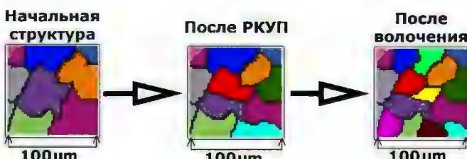
Рис. 1 Изменение размера зерна в медной оболочке
